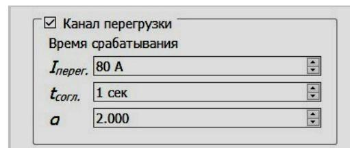
умолчанию канал перегрузки отключен, поля параметров настройки канала неактивны. Канал включается установкой значка **V** в специальном поле в названии блока.
