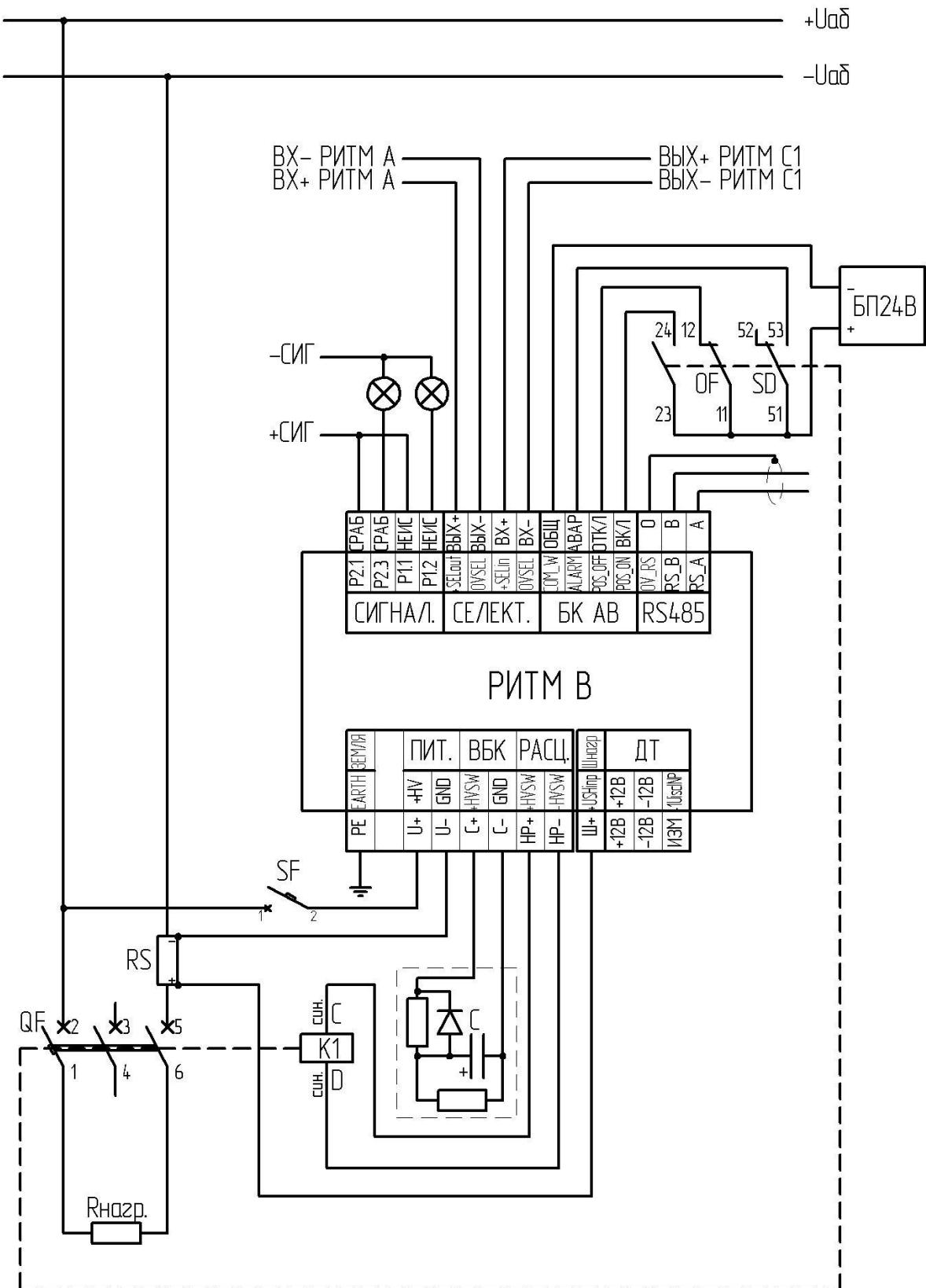
Рис.1 – Схема подключения реле РИТМ.
