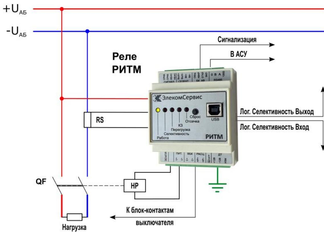
После подачи напряжения питания реле постоянно контролирует ток, протекающий по защищаемому участку сети, напряжение сети, целостность цепей логической селективности и независимого расцепителя, положение контактов и состояние управляемого защитного аппарата, наличие связи с АСУ ТП. Периодически проводится контроль обмотки независимого расцепителя (проверка целостности обмотки и отсутствия в ней короткого замыкания).
