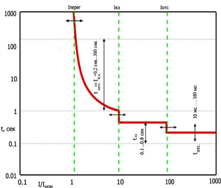
Алгоритм работы реле РИТМ и диапазоны возможных уставок представлены следующим графиком. Здесь  $I_{изм}$  – измеренное значение тока. В диапазоне токов  $I_{перер} < I_{изм} \leq I_{кз}$  работает канал перегрузки, в диапазоне  $I_{кз} < I_{изм} \leq I_{отс}$  работает канал КЗ, в диапазоне  $I_{отс} < I_{изм}$  работает канал отсечки.
