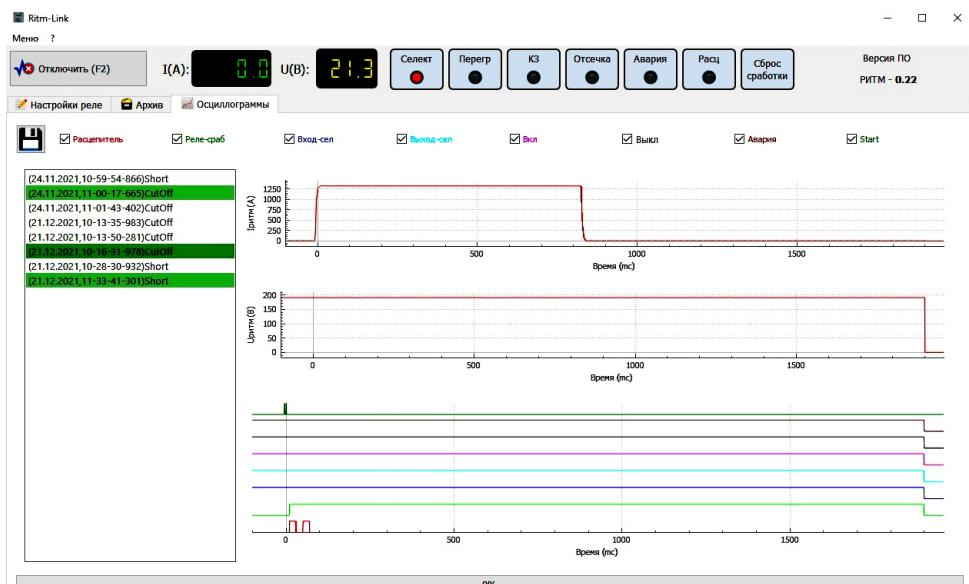
При переходе на экран Осциллограммы автоматически формируется список осциллограмм, сохранённых в памяти реле РИТМ, он отображается в левой части экрана. Название каждой
